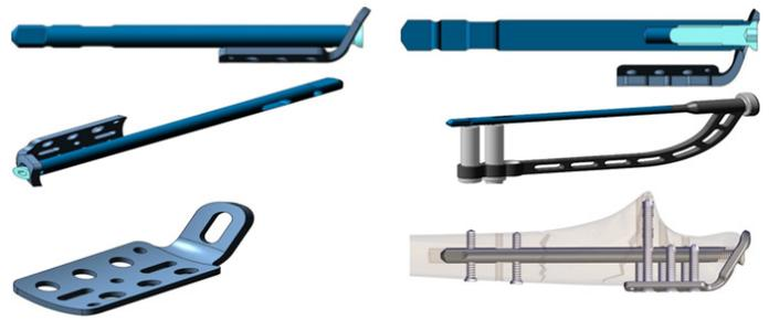
Рисунок 3. Схема фиксатора
