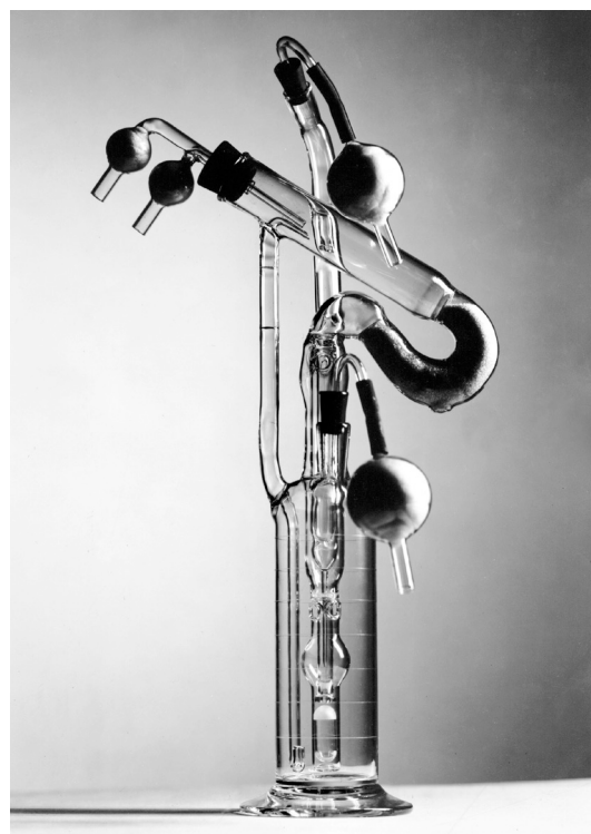
Рисунок 1. Аппарат для перфузии целых органов, разработанный Алексисом Каррелем, Чарльзом Линдбергом и Отто Хопфом (1935). Орган помещен в герметичную камеру из выдувного стекла Pyrex и подключен к системе стеклянных трубок, имитирующих кровообращение. Фото: Луи Шмидт и Джозеф Б. Хауленбек, 1935. Цифровая коллекция Университета Рокфеллера
