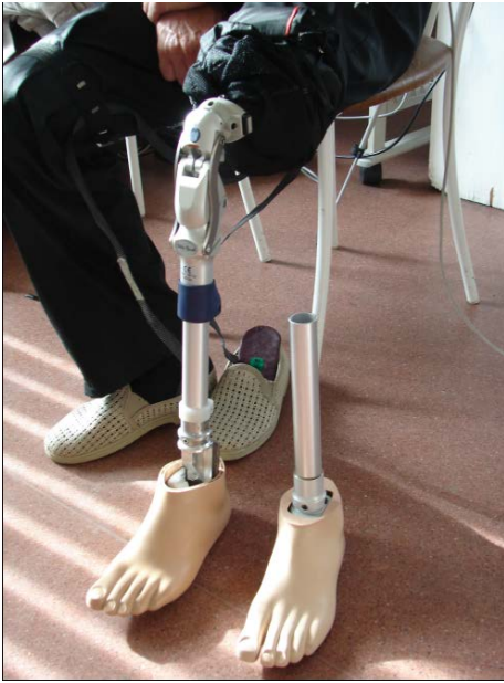
Рисунок 5. Испытуемые стопы: слева – экспериментальная (смонтированная на протезе бедра); справа – стопа 1D35 «Отто-Бокк» Figure 5. Tested feet: on the left - experimental (mounted on a hip prosthesis); right – foot 1D35 "Otto-Bock"
