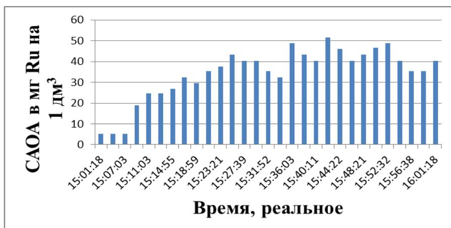
**Рис. 2.** Изменение суммарной антиоксидантно активности (CAOA) воды при насыщении молекулярным водородом
